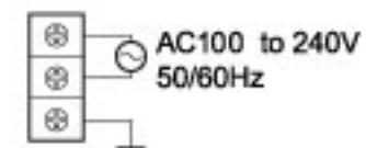
(Прим 1) При входном сигнале постоянного тока подключите дополнительное параллельное сопротивление к терминалу ввода напряжения.
